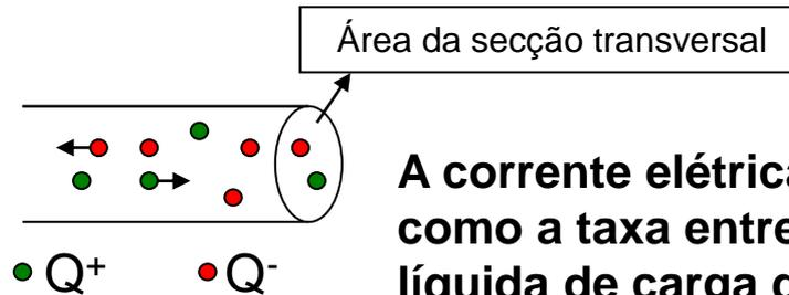
**A corrente elétrica será definida como a taxa entre a variação líquida de carga que atravessa uma secção transversal do meio físico em um determinado período de tempo, ou seja:**
