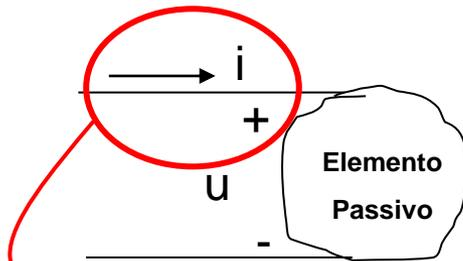
Seta da corrente entra no terminal positivo da tensão, diz-se que o elemento tem polarização de elemento passivo.
