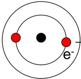
Quando se fornece ou retira energia do elétron ( $e^-$ ), pode-se movimentá-lo por entre as camadas (K, L, M, N...). No limite, pode-se fornecer energia suficiente para que o elétron se desprenda do átomo, gerando uma carga negativa, o elétron, e uma carga positiva, representado pelo íon composto pelo átomo desequilibrado em sua composição.
