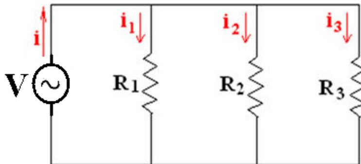
Onde, a fonte representa a alimentação em corrente alternada disponibilizada pela concessionária de energia e as resistências representam as cargas instaladas, tais como, iluminação, chuveiro, torneira elétrica, forno elétrico, microondas e outros equipamentos.
