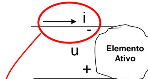
Seta da corrente entra no terminal negativo da tensão, diz-se que o elemento tem polarização de elemento ativo.
