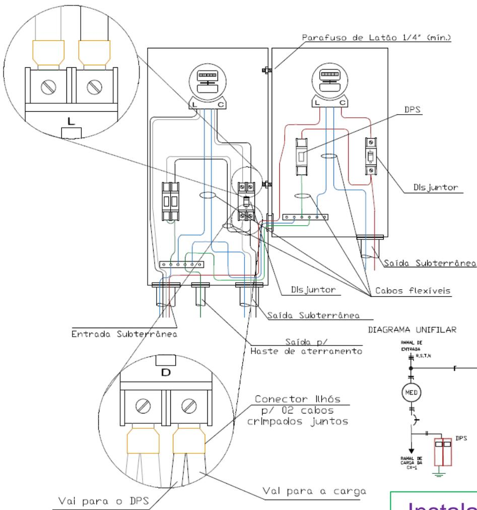
Para edificação sem Sistema de Proteção Contra Descargas Atmosféricas (SPDA), o DPS deverá ser classe II, com corrente nominal de descarga mínima de 5 kA, condutor de ligação mínimo de 4mm<sup>2</sup> e **tensão máxima de operação de 275V**, instalado conforme NBR5410;
