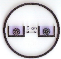
5 cm em cabeamento horizontal
