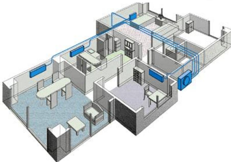
A proposta de usar Multi-Split deve ser restrita para o caso em que a área técnica for de dimensões reduzidas, pois, em havendo problemas na condensadora, não se poderá utilizar as evaporadoras.
