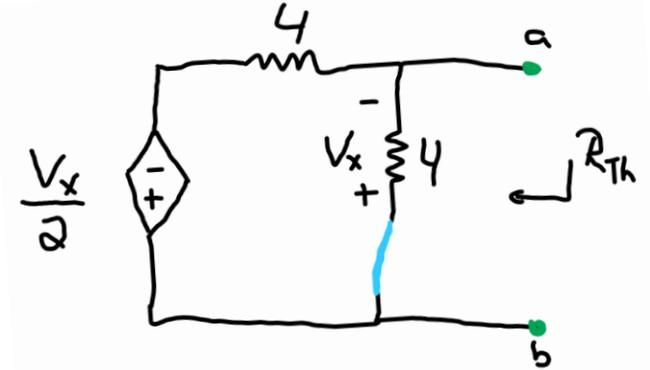
Assim, se utilizará um fonte de tensão independente de 1V e, polarizando o circuito, tem-se:
