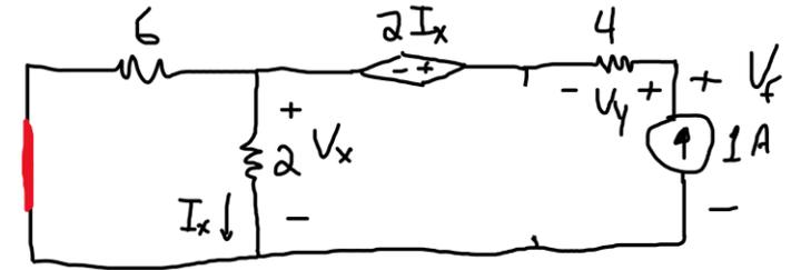
Na malha da fonte de corrente se pode escrever:  $-V_x - 2 \cdot I_x - V_y + V_f = 0 \Rightarrow V_f = V_x + 2 \cdot I_x + V_y$
