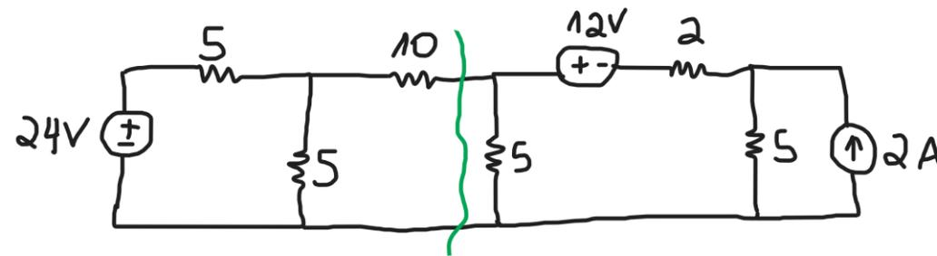
Tomando-se a rede à esquerda dos terminais a e b =>
