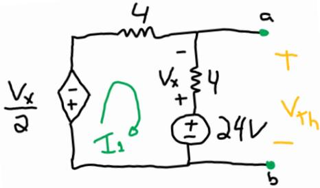
$$\text{Aplicando LKT em } V_{Th} \Rightarrow V_{Th} - 24 + V_x = 0 \Rightarrow V_{Th} = 24 - V_x \quad (1)$$
