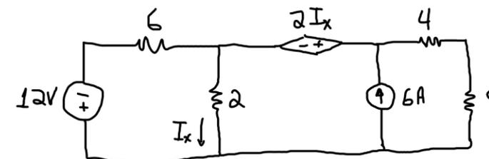
Retirando o resistor de  $8\Omega$  e “matando” as Fontes Independentes, se tem:
