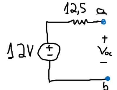
IMPORTANTE: Para qualquer circuito, se pode obter o Equivalente de Thévenin à partir de qualquer par de nós, ou seja, obter o equivalente à direita, à esquerda do par de nós e, inclusive, obter o equivalente visto por qualquer dos elementos do circuito.
