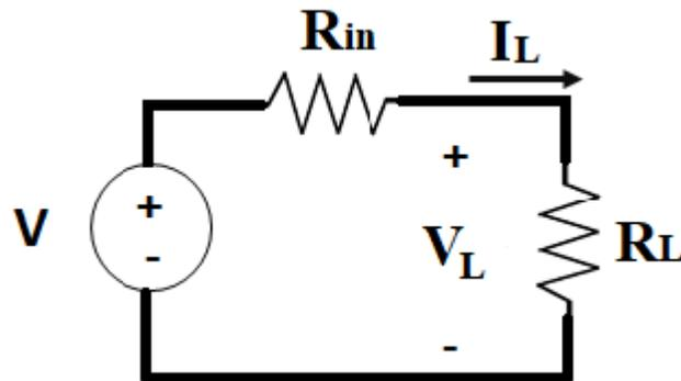
Dada a fórmula da potência para  $R_L$ :  $P_L = R_L \cdot I_L^2$  Considerando:  $I_L = \frac{V}{(R_{in} + R_L)}$  Então:  $P_L = \frac{R_L \cdot V^2}{(R_{in} + R_L)^2}$
