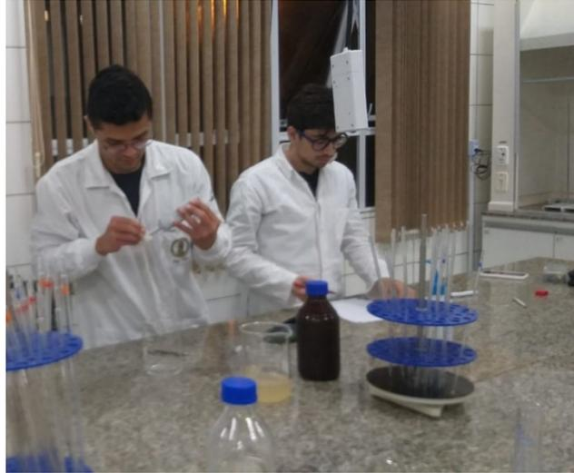
Figura 7 Prepara da titulometria para determinação da curva de pH usada em *Jar Test*
