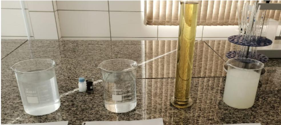
Figura 13 aparatos para determinação da viscosidade pela segunda lei de Stokes
