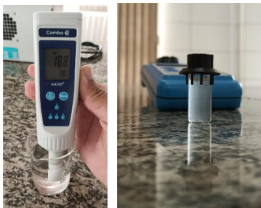
Figura 10 Determinação de condutividade elétrica e turbidez amostras tratadas
