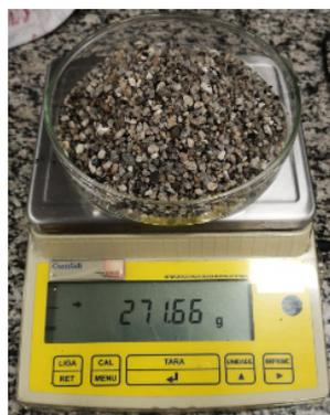
Figura 14 Determinação gravimétrica da textura de meio porosos
