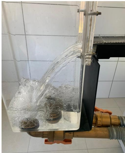
Figura 21 Calibração da curva volumétrica do canal estreito
