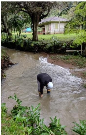
Figura 6 Determinação da vazão do corpo hídrico que receberá efluente tratado
