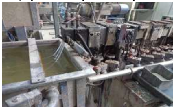
Fig. 1- Produção por extrusão da poliamida 66 suportadas com ZnNPs.
