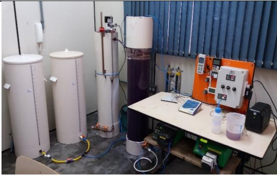
- Unidade de experimental – eletrobiorreator a membrana
