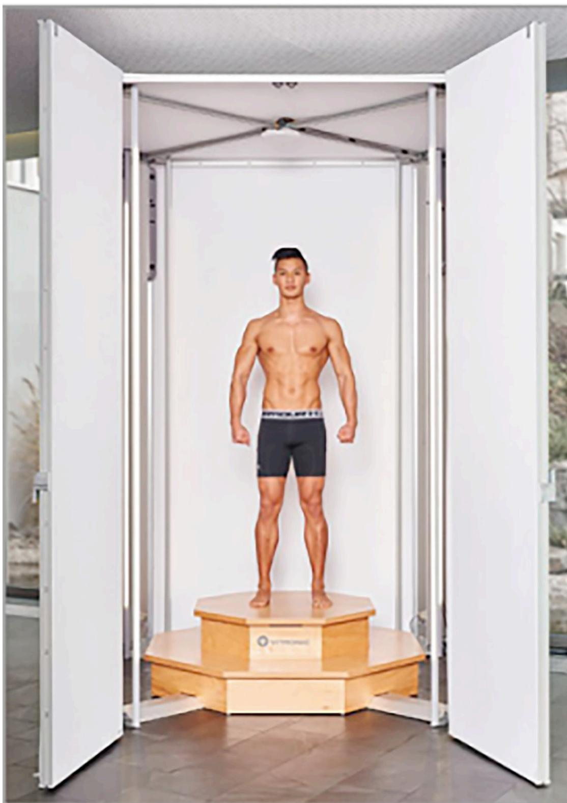
Figura 6 - Scanner tridimensional modelo Vitus Pro da Tecmath
