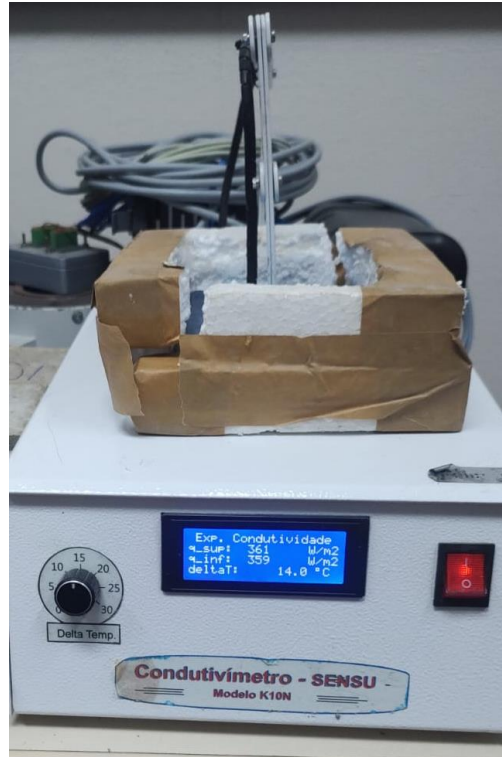
Figura 22 – Ensaio condutividade térmica
