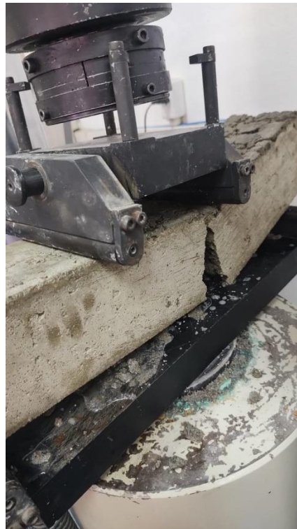
Figura 21 – Rompimento corpo de prova ensaio tração na flexão
