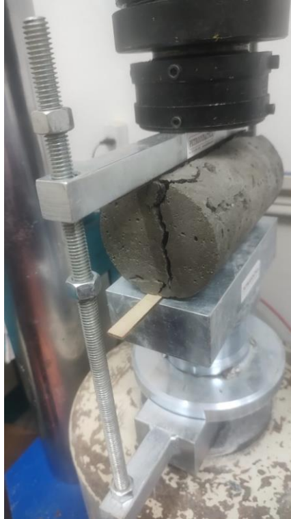
Figura 20 – Rompimento corpo de prova ensaio tração por compressão diametral
