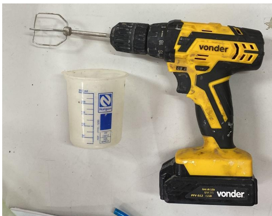
Figura 27 – Equipamento de mistura das pastas de cimento
