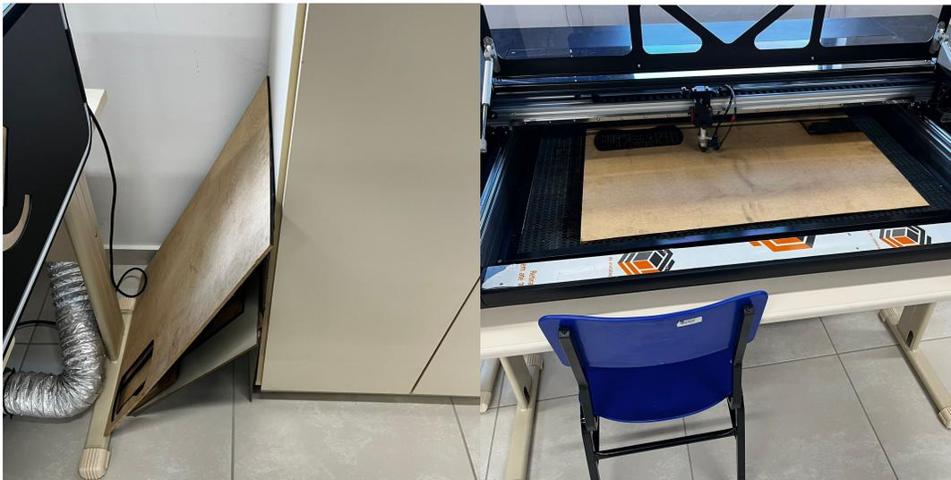
Com a máquina ligada, um led vermelho marcará o ponto onde vai ser cortado, e dentro do software, com o todo o desenho selecionado, é necessário clicar em “Preview”, para ver como a impressora irá desenhar a peça.
