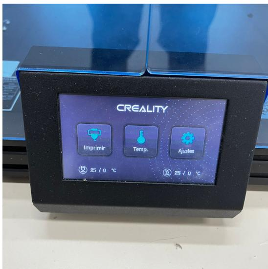
(3) Voltando para o início, existe ainda a opção de “Temp.”, que é a temperatura da mesa e do bico
