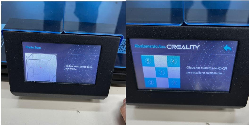
Apertando em Nivelamento o cabeçote vai para o ponto zero, e é possível ajustar a mesa de impressão, utilizando os 5 pontos principais da máquina.
