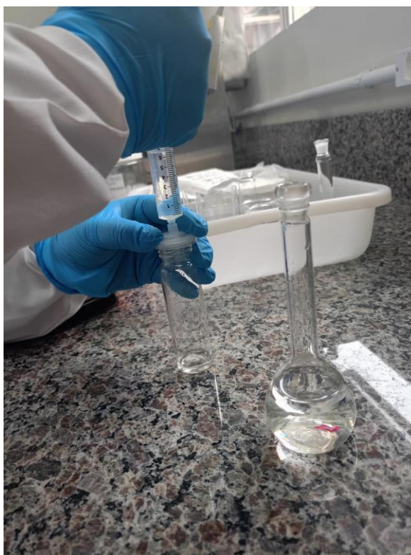
Figura 11 – Amostra de água filtrada sendo filtrada pelo filtro de seringa.
