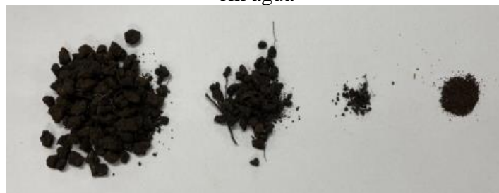
Figura 21 – Representação da agregação de um solo submetida a estabilidade de agregados em água
