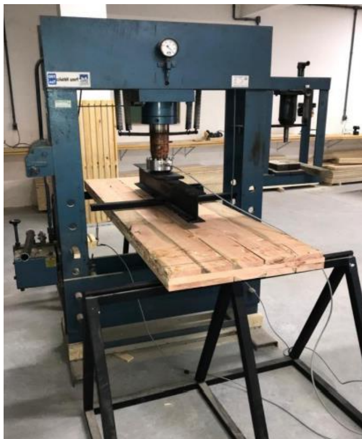
Figura 12 – Ensaio de flexão à três pontos de CLT experimental de E. benthamii
