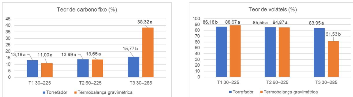
(a) Teor de carbono fixo, comparando a torrefação em torrefador de tambor e termobalança.
