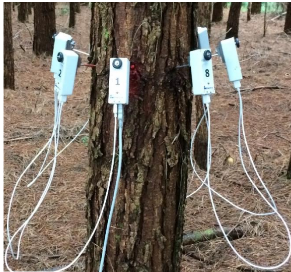
Figura 4 - Posicionamento dos sensores na secção transversal do lenho das árvores.
