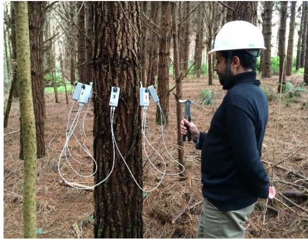
Figura 5 - Aplicação das pancadas de martelete para produção de ondas mecânicas.
