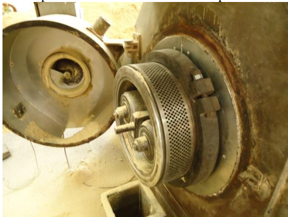
Figura 1.9 – Equipamento utilizado para peletização em Benedito Novo, detalhe para a matriz onde se formam os pellets.
