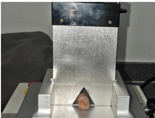
Figura 10- Determinação da força de cisalhamento
