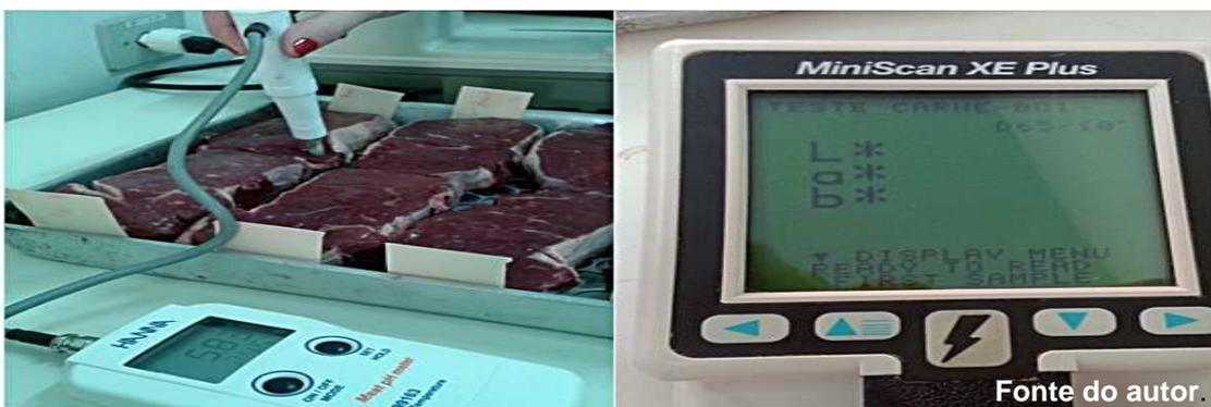
Figura M: Peagômetro portátil para leitura de pH; Figura N: Colorímetro portátil para leitura da cor das amostras de carne.
