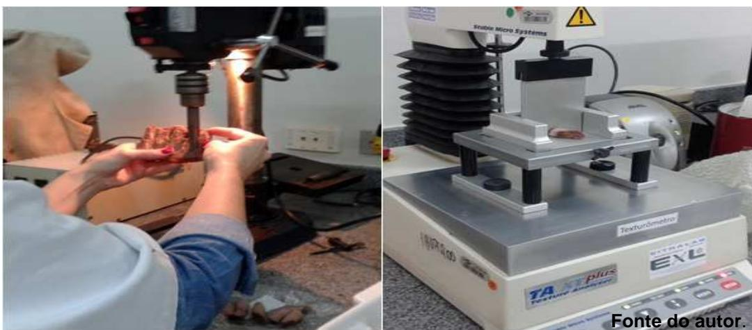
Figura P: Vazador para retirada das sub – amostras; Figura Q: Texturômetro.
