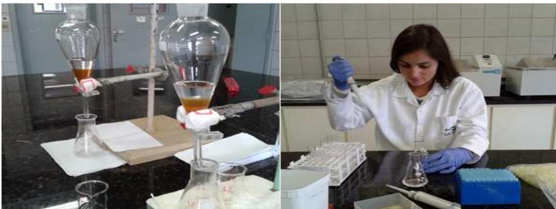
Figura T: Funil de separação das amostras; Figura U: Separação de 3 ml de extrato de hexano.
