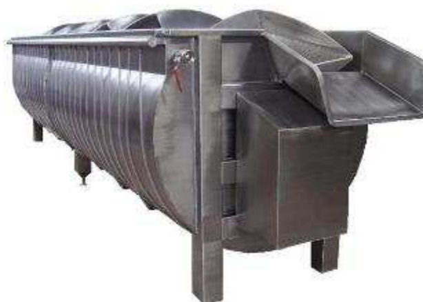
Figura 3. Chiller de cozimento de bexiga e estômago. Fonte: www.ebah.com.br
