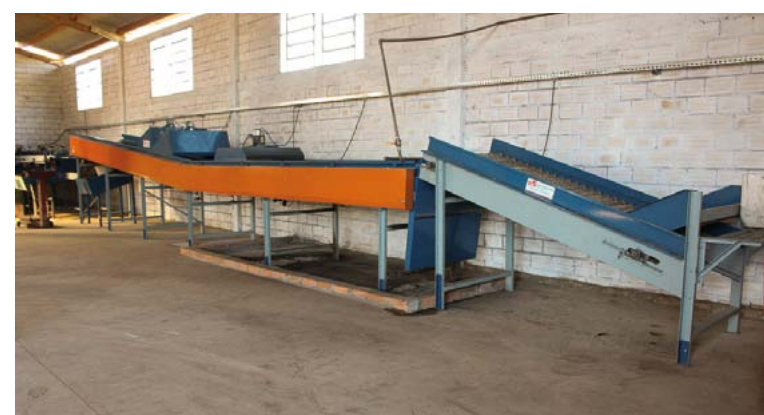
Figura 2. Máquina para limpeza, secagem, polimento e classificação das laranjas.
