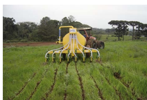
Figura 2. Aplicação de dejetos com sistema injetado ao solo - diminui o mal cheiro e perdas de nutrientes
