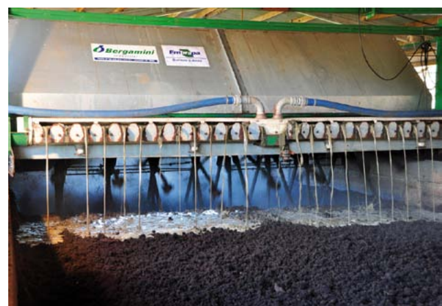
Figura 2. Detalhe da fase de impregnação: o dejetos suíno líquido sendo aplicado sobre o composto com serragem.
